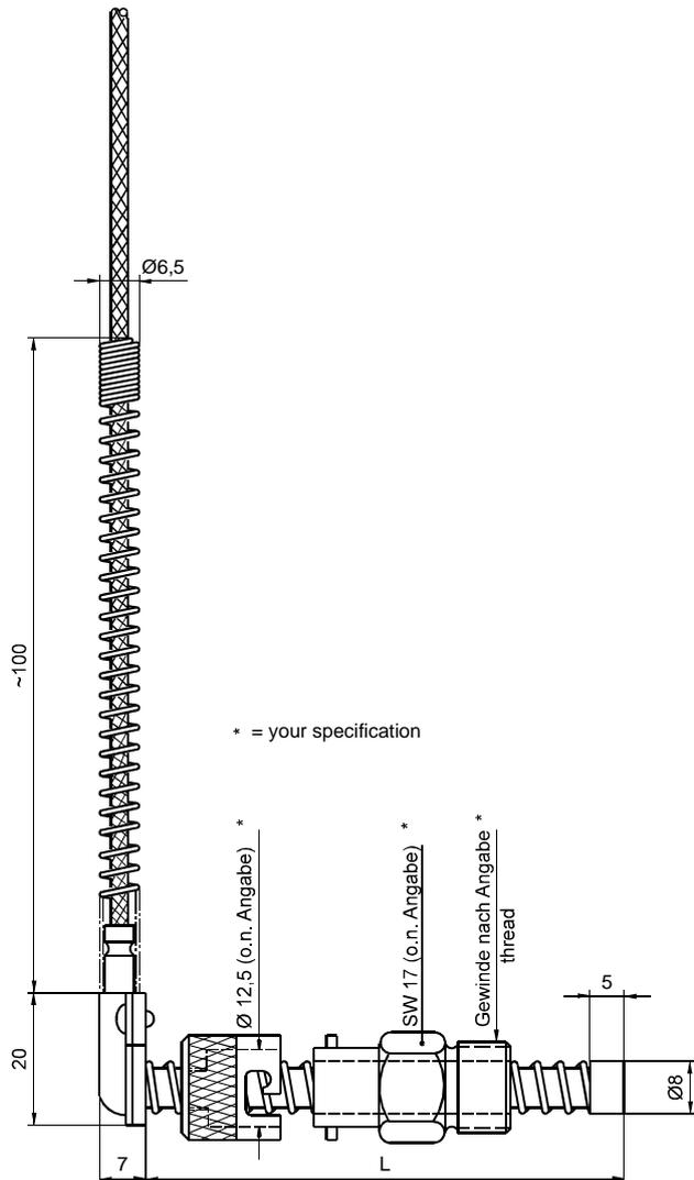
**thermoelectric voltages** : Fe-CuNi ½ DIN 43710 (L)
