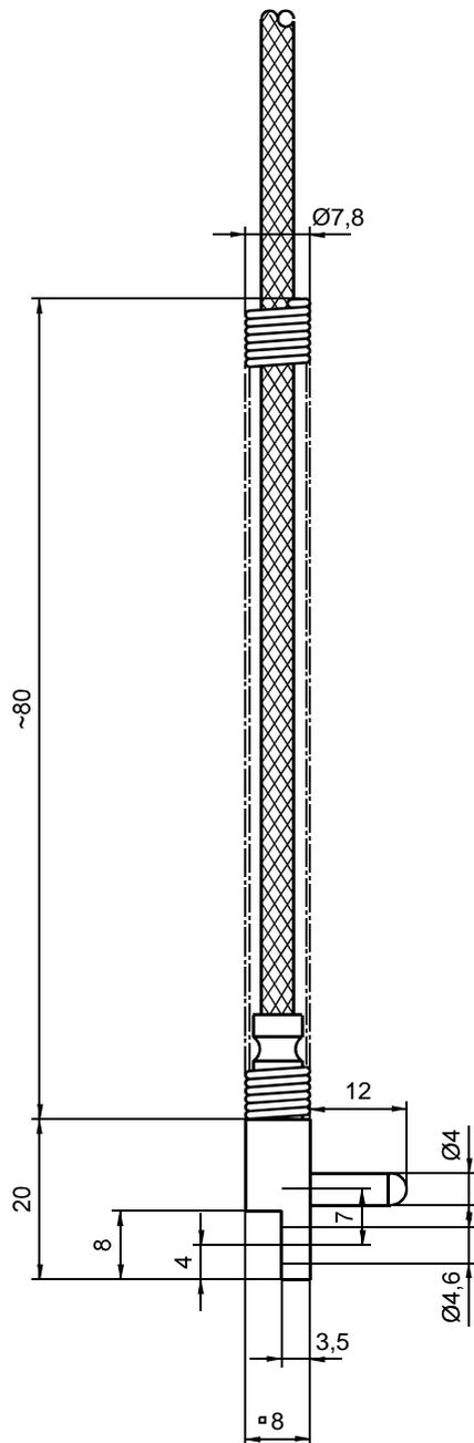
**thermoelectric voltages** : Fe-CuNi ½ DIN 43710 (L)
