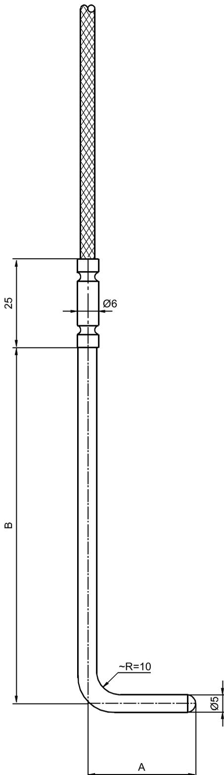
**Thermospannungen :** Fe-CuNi ½ DIN 43710 (L)
