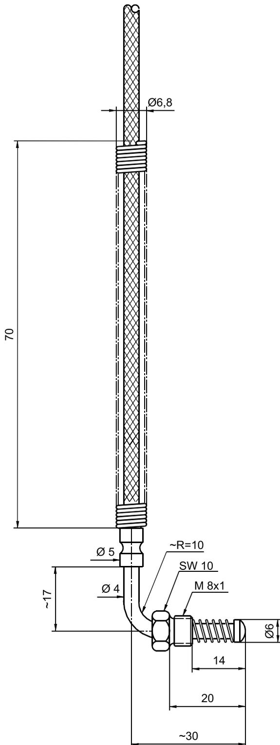
**Thermospannungen :** Fe-CuNi ½ DIN 43710 (L)
