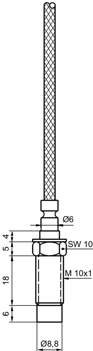
**Thermospannungen** : Fe-CuNi ½ DIN 43710 (L)
